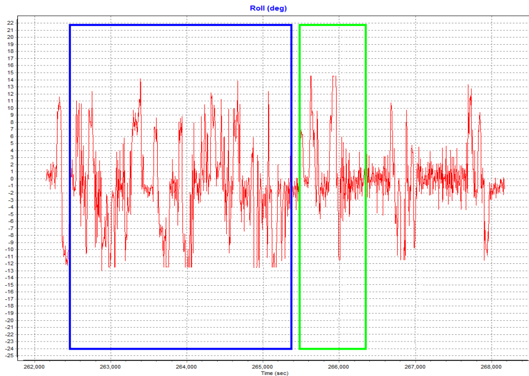
率定飛航航線掃瞄姿態滾動(roll)傾角 (藍色框為率定；綠色為確認飛行)
