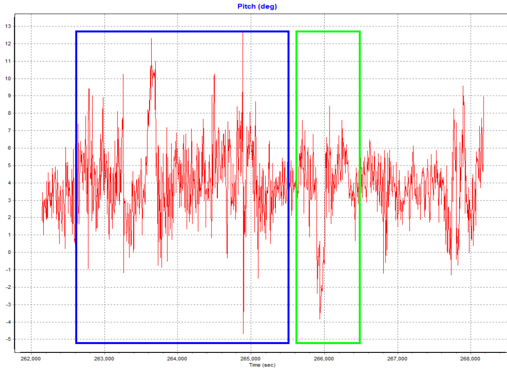
率定飛航航線掃瞄姿態顛簸(pitch)傾角 (藍色框為率定；綠色為確認飛行)
