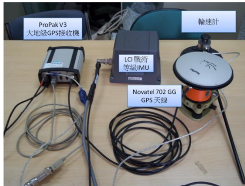
圖 3.11 多元感測器定位定向系統之整合架構
