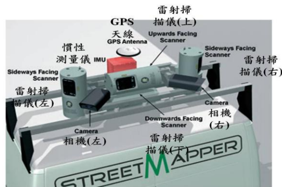
圖 2.12 Street mapper 車載 MMS(Street Mapper 提供)
