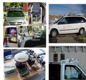
圖 4.48 整合式定位定向系統精度測試項目 (Chiang, 2004; Shin,2005)
