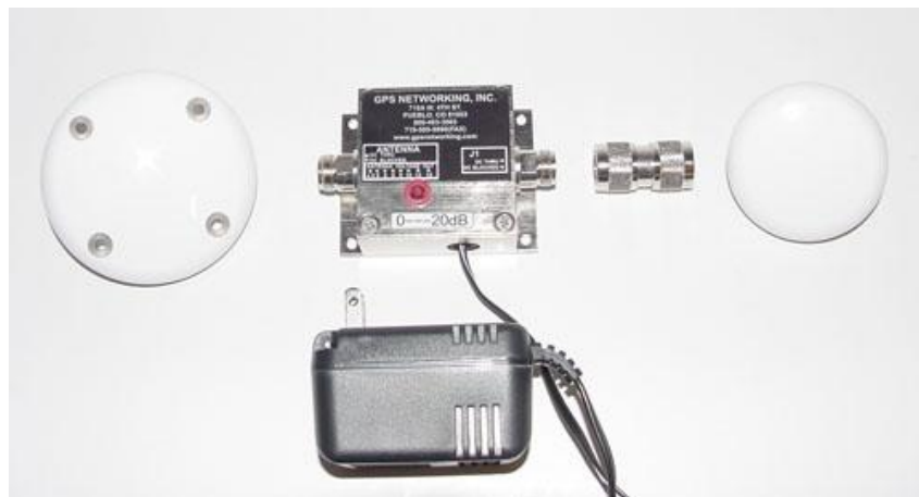
圖 4.52 雙頻雙系統之 GNSS 訊號室內播放設備
