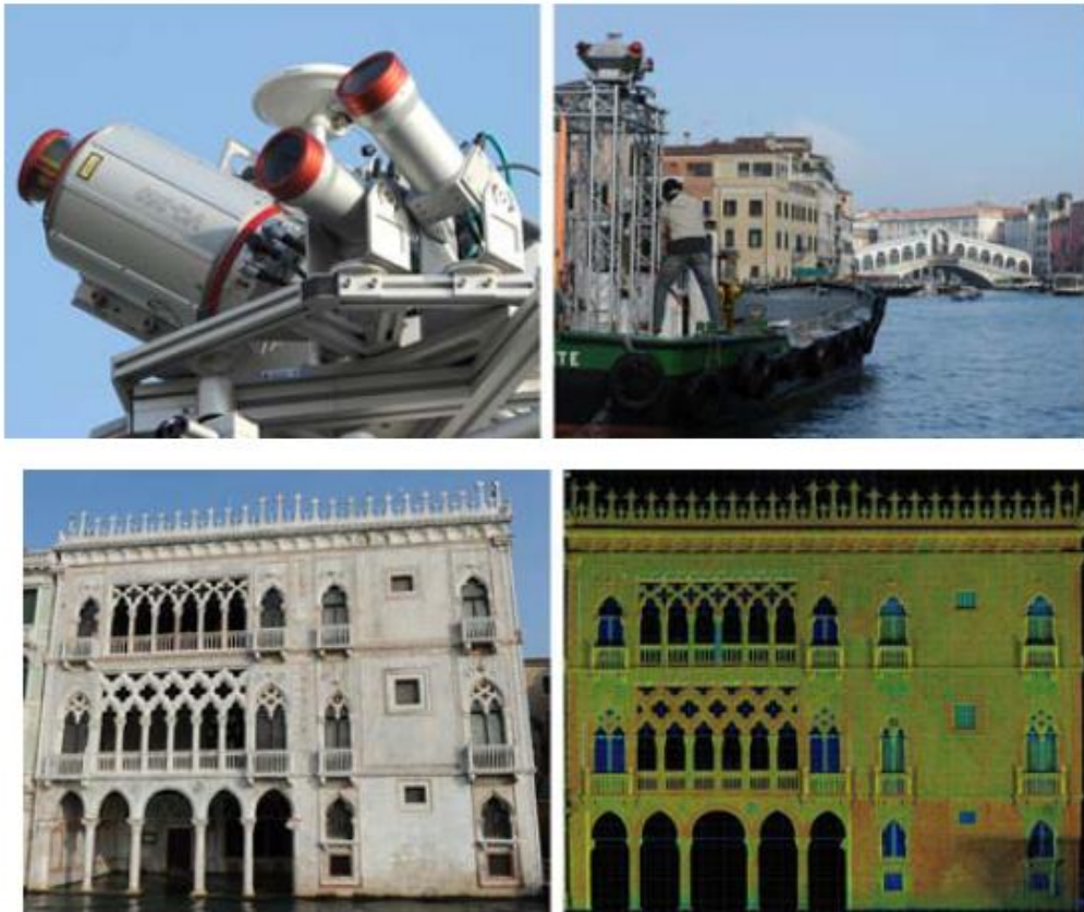
圖 2.32 船載光達移動遙測製圖系統架構(上)與作業成果(下) (摘自 Zach et al., 2011)
