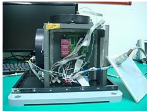
圖 3.10 LCI 慣性測量儀規格與尚未封裝前之照片
