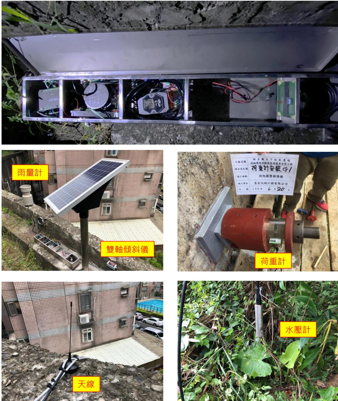
圖5-4 現場監測儀器裝設完畢後照片
