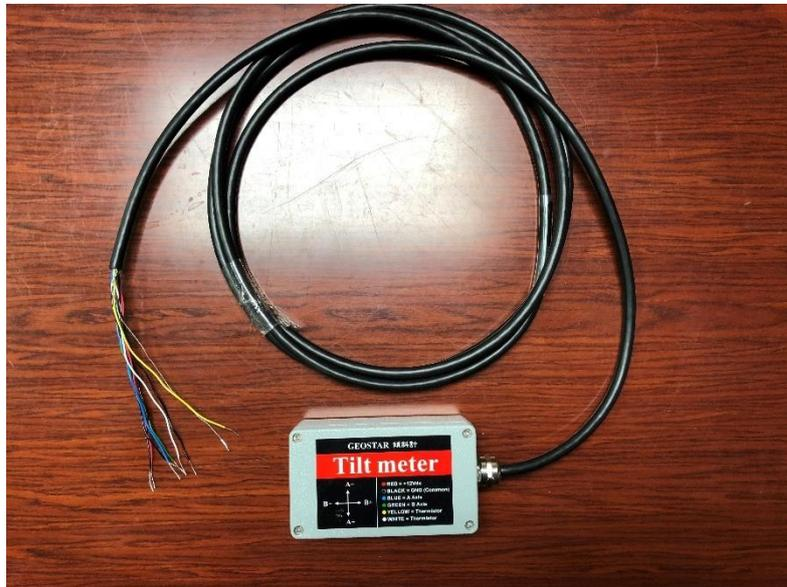
圖3-1 雙軸傾斜儀
