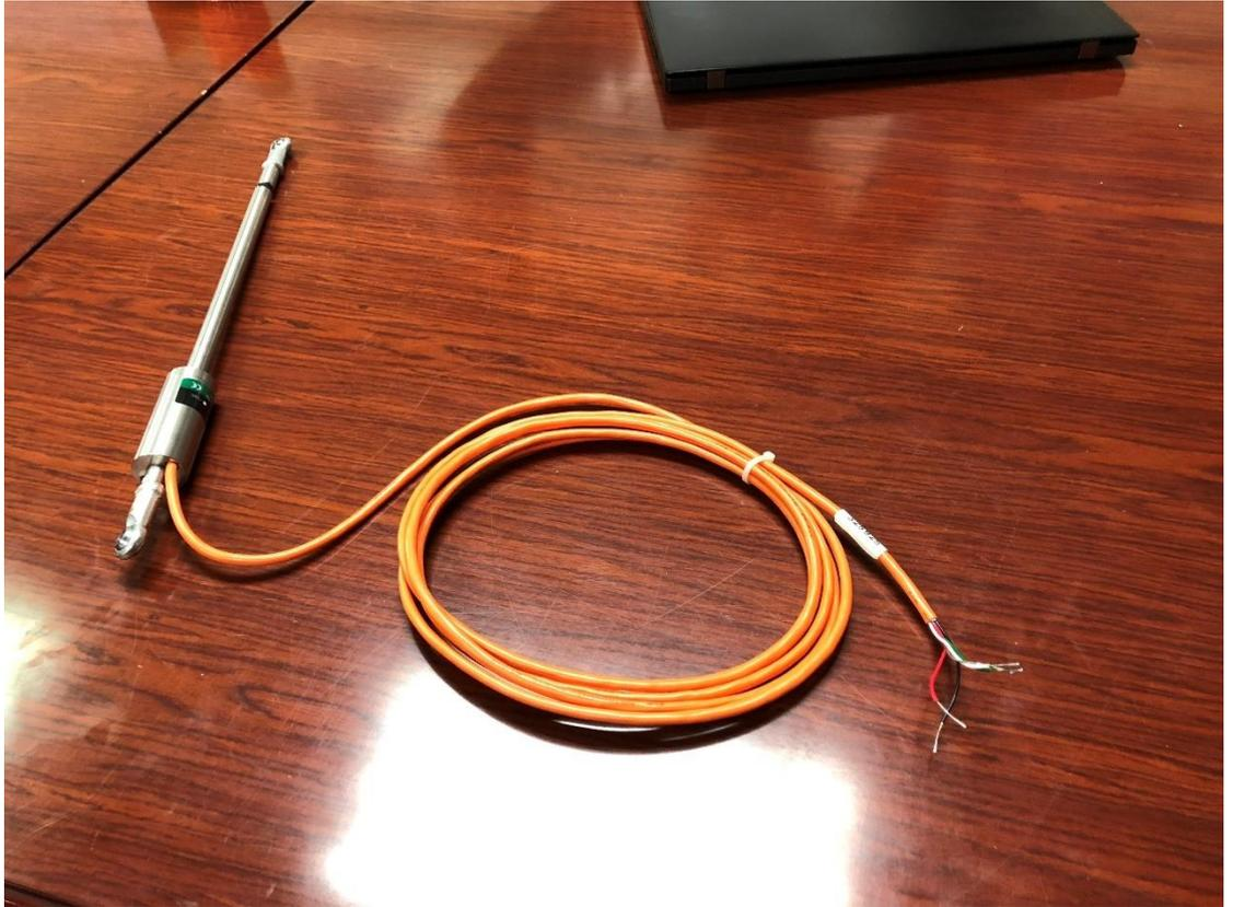
圖3-2 振弦式裂縫計
